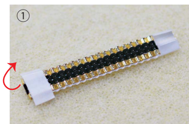
シート両端の両面テープの剥離紙を左右に開きたて糸と一緒に折り返す。シートの両端に固定します。
